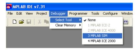
Dans le menu Debugger, de nouvelles sélections apparaissent. Choisir settings pour définir quelques options pour la simulation, en particulier la fréquence de l'horloge dépendant du PIC choisi (4 Mhz pour un 16F84A).
