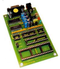
Le PIC-01 permet la programmation des microcontrôleurs PIC de chez MICROCHIP (familles PIC12Cxxx, PIC12Cxxx, PIC16Cxxx et PIC16Fxxx), ainsi que les EEPROM séries (famille 24 Cxx). Connectable sur le port série de tout compatible PC, il fonctionne avec un logiciel sous Windows 95/98/NT/2000 et maintenant XP. Il supporte les boîtiers DIP 8, 18, 28 et 40 broches permettant la programmation de plus de 60 composants différents.
