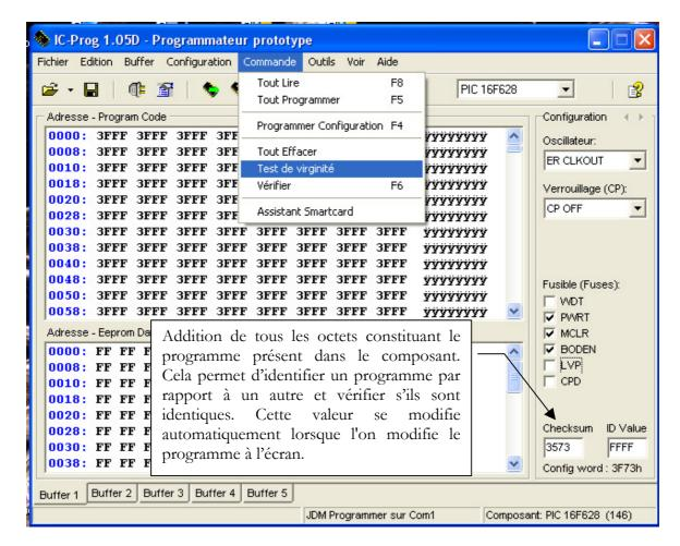
Si le composant est vierge ou effacé tous les bits de la mémoire seront au niveau logique 1 (FF). Cette fonction est à utiliser avant toute programmation car il n'est pas possible de programmer un composant correctement si celui-ci n'est pas vierge ou n'a pas été effacé préalablement. Si ce n'est pas le cas, il faut effacer le composant : menu "Commande\Tout Effacer".
