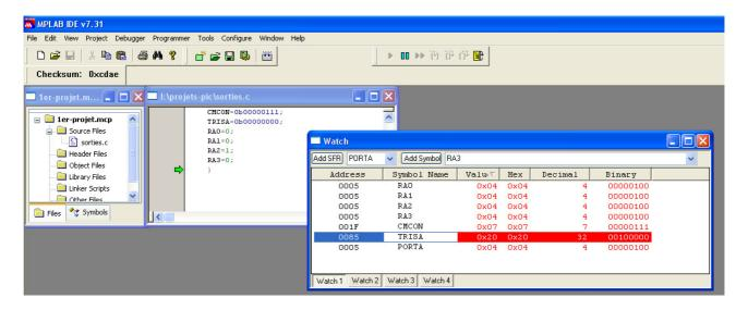
Lancer l'exécution de la simulation. On observe alors la modification des valeurs des registres et du port de sortie.
