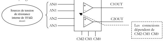
Les fonctions de comparaisons réalisées sont définies par les bits CM2 CM1 et CM0 du registre CMCON (Cf  $\,$   $\,$  4.3).
