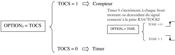
Avec une horloge à 4 MHz, l'incrémentation se fait toutes les 1 µs (4 cycles par période d'horloge) Timer 0 s'incrémente à chaque cycle s'il n'y a pas de prédiviseur. En cas d'opération d'écriture dans le timer, l'incrémentation est inhibée pour les 2 cycles suivants.
