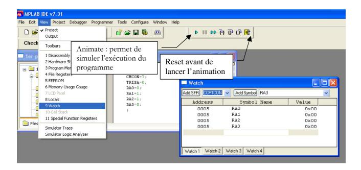
La compilation ayant été réalisée auparavant, on peut sélectionner Add symbol, RA0 pour visualiser l'état de RA0 lors de la simulation du programme.
