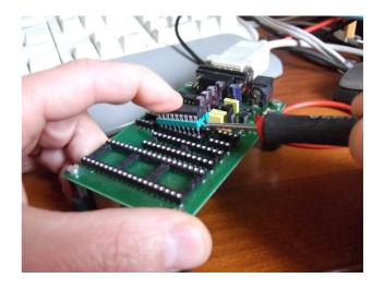
Implanter le composant et son support sur une platine d'essais type Labdec.
