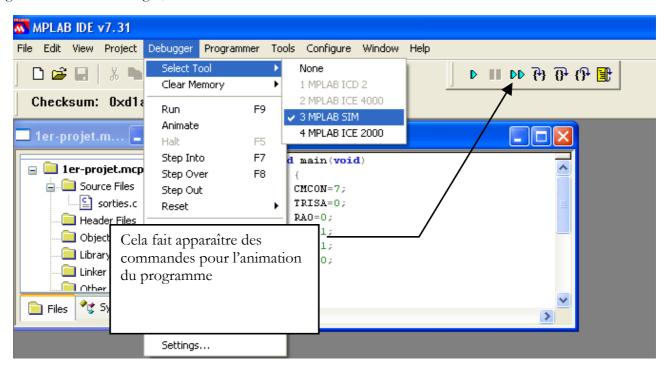
Dans le menu Debugger, de nouvelles sélections apparaissent. Choisir settings pour définir quelques options pour la simulation, en particulier la fréquence de l'horloge dépendant du PIC choisi (4 Mhz pour un 16F628 utilisé avec l'horloge interne (Cf Configuration bits INTRC I/O sur on).
