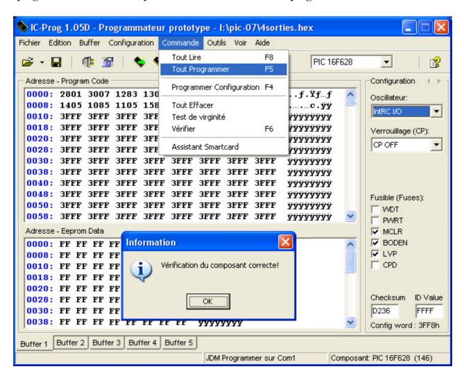
Lorsque le transfert du programme dans le pic est réalisé, le logiciel procède à une vérification. Si un message d'erreur apparaît, il peut s'agir d'un mauvaise connexion du programmateur (erreur de port série) ou d'une mauvaise alimentation du programmateur.
